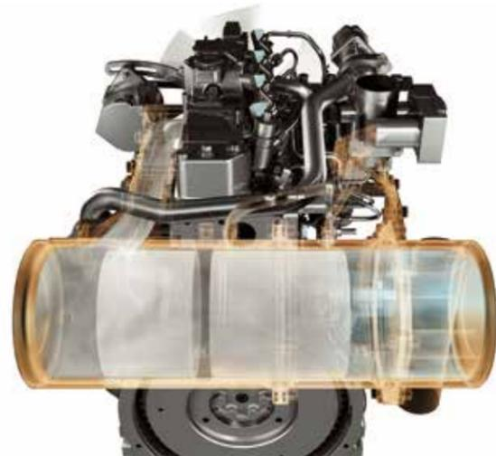
FPD (filtre à particules pour moteurs diesel)
